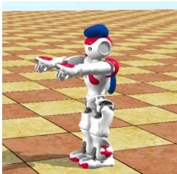
شکل ۴-۴۰- نمایی از ربات نائو همراه اتصال دو شیء خارجی روی سر و کمر آن
