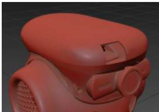
شکل ۳۶-۴- طراحی بخش اول محافظه کلاه-مانند برای جاسازی دوربین و ویدئو پروژکتور
