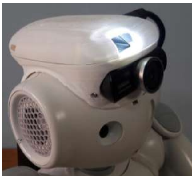
شکل ۴-۳۷-نمایی از روبوداک به همراه دوربین و ویدئو پروژکتور جاسازی شده
