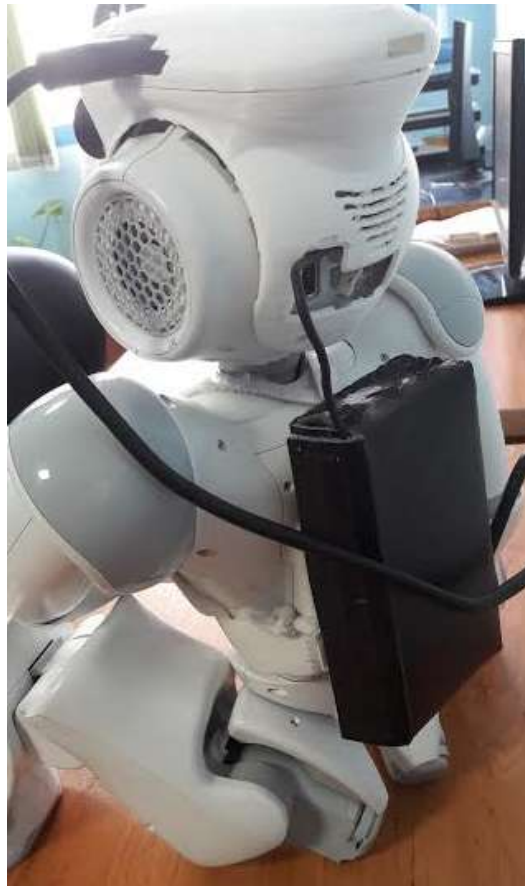
شکل ۴-۳۸- محل جاسازی بُرد رسی‌ری، روی بدن ربات
