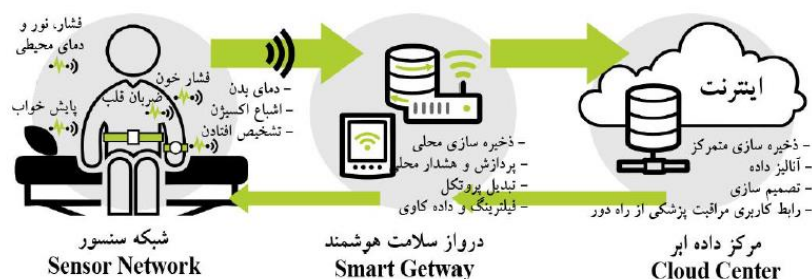
شکل ۳ سامانه نظارت بر سلامت مبتنی بر اینترنت اشیا (Rahmani et al., 2018)
